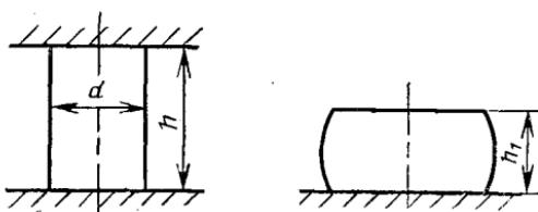
1.4. Образцы должны быть с необработанной поверхностью. Применение образцов с механически обработанной поверхностью должно быть указано в нормативно-технической документации на металлопродукцию.
